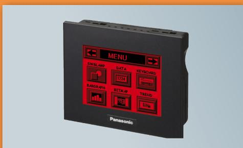
Il **GT05** è un touch screen dotato di un display STN monocromatico da 3.5" (320x240 pixel) con backlight LED a tripla colorazione (rossa,arancio,verde). Si caratterizza per le dimensioni estremamente compatte (profondità di soli 33.8 mm) e soprattutto per l'eccellente visibilità e luminosità del display. Sono disponibili una porta USB per la programmazione, una seriale RS232C per la comunicazione ed uno Slot per SD/SDHC Card (upload/download progetto hmi/plc Panasonic e data logging).
